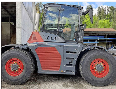
Beide Achsen sind gelenkt. Alle Antriebskomponenten sind unter der Kabine. (Bilder: Daniel Hasler)
