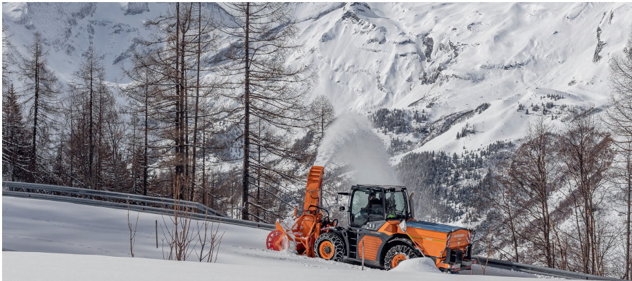
Ein besonders gutes Kurvenverhalten ergibt sich durch die Lenkbarkeit von Vorder- und Hinterachse.
