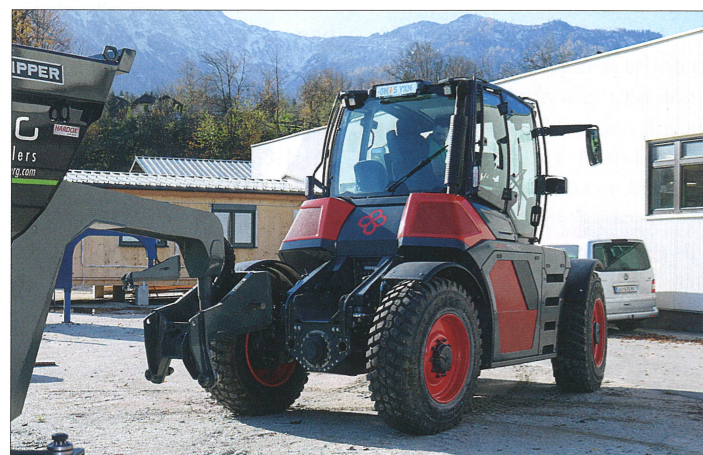
Ankuppeln sämtlicher Verbindungen in ca. 60 Sekunden. Der Fahrer braucht dafür nicht abzusteigen.
