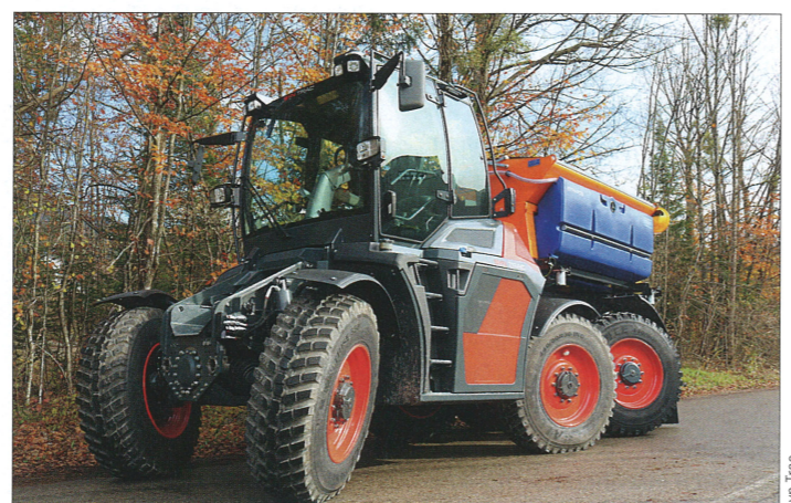
Aus dem Traktor wird im Handumdrehen ein dreiaxsiges Spezialfahrzeug. Alle drei Achsen sind lenkbar.
