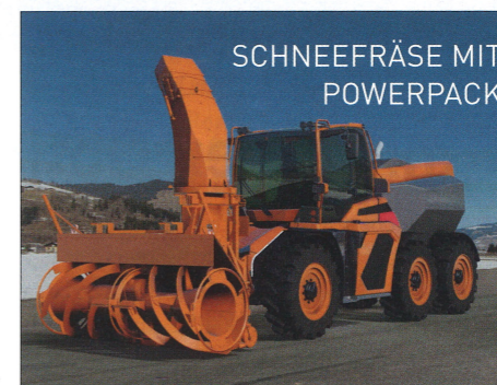
Das angehängte Powerpack steigert die Leistung des Gespanns auf bis zu 1000 PS.
