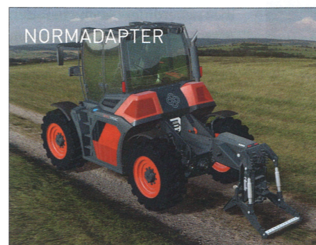
Mit dem Normaladapter sind konventionelle Geräte zu koppeln.
