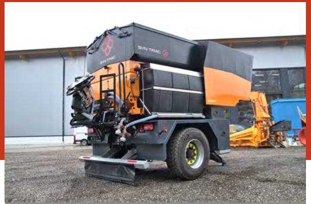
Das 3AX-Basismodul haben die Österreicher gemeinsam mit den Winterdienst-Spezialisten von Kugelmann entwickelt. Damit lässt sich der Geräteträger um eine Achse erweitern.
